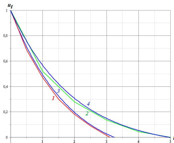
Рис. 13. Графики скоростей на конце ( x = 0 ) стержня: кривые 1 и 2 – точное решение, 3 и 4 – приближенное решение, соответственно для \mu = 0.3 и \mu = 0.1 . Figure 13. Graphs of velocities at the end ( x = 0 ) of the rod: curves 1 and 2 are the exact solutions, 3 and 4 are the approximate solutions, for \mu = 0.3 and \mu = 0.1 , respectively.
