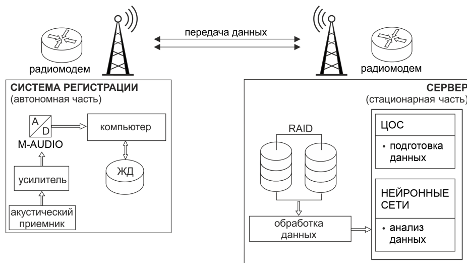
Рис. 1. Структурная схема аппаратно-программного комплекса. [Figure 1. Structural scheme of the hardware-software complex.]
