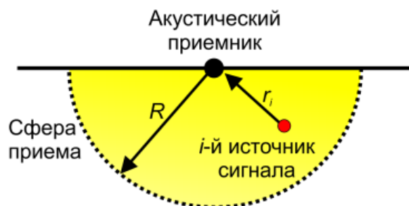
Рис. 1. Схема приёма сигнала геоакустической эмиссии в пункте наблюдений [Figure 1. Scheme for receiving a geoaoustic emission signal at an observation point]
