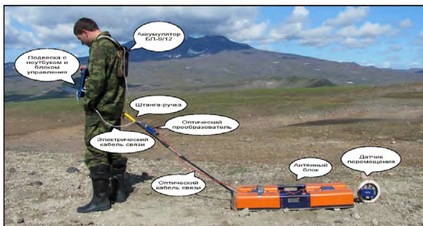
Рис. 9. Оператор с георадаром «ОКО-2» в районе Мутновско-Гореловской группы вулканов (Камчатка). На заднем плане вулкан Горелый (фото В.Ю. Павловой).
