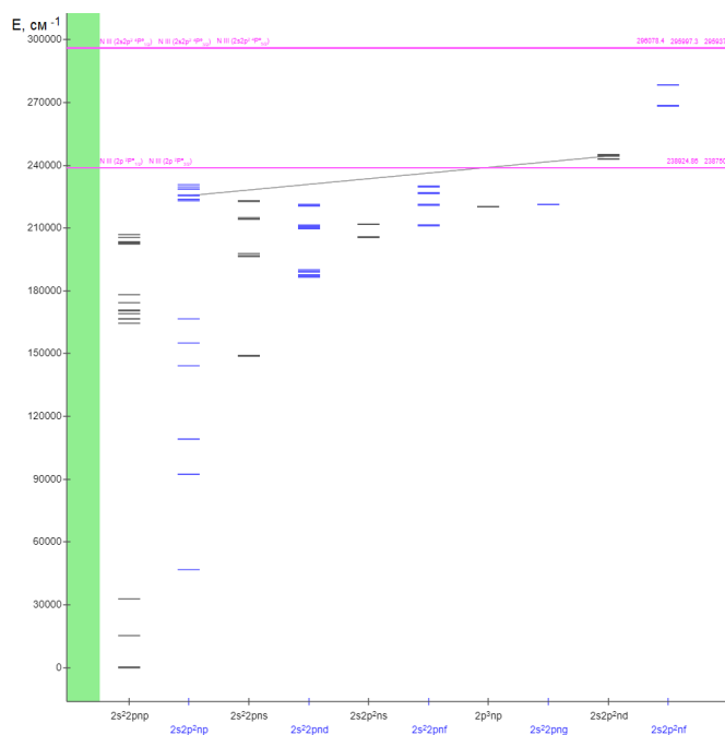
Рис. 8. Диаграмма Гротриана N^+ , 532 нм. [Figure 8. Grotrian diagram of N^+ , 532 nm.]
