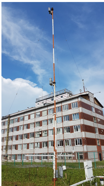
Рис. 2. Внешний вид метеорологической мачты с установленными детекторами ионизирующих излучений ТОРИИ
