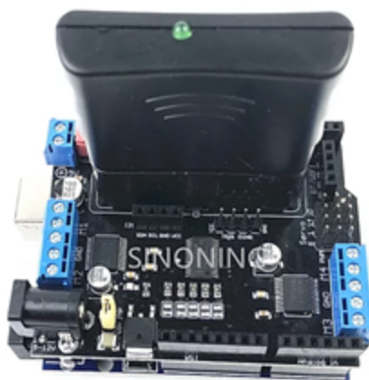
Рис. 7. Плата расширения B6612FNG V3.0 с PSX2, соединенная с платой микроконтроллера Arduino Uno R3
