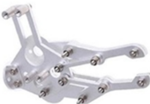
Рис. 5. Захват для манипулятора учебного робота
