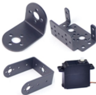
Рис. 3. Комплектующие детали для сборки одного звена манипулятора учебного робота
