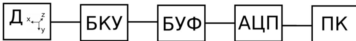
Рис. 2. Блок-схема геоакустического измерительного комплекса. Д – датчик сигналов (трехкомпонентный пьезоэлектрический сейсмоприемник), БКУ – блок кабельных усилителей, БУФ – блок усиления и фильтрации (три независимых канала), АЦП – блок аналого-цифрового преобразования, ПК – персональный компьютер [3].
