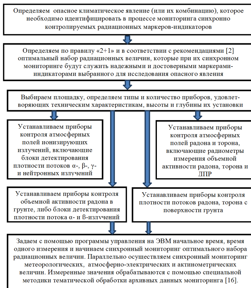
Рис. 4. Алгоритм мониторинга оптимального набора синхронно контролируемых радиационных маркеров-индикаторов опасных явлений
